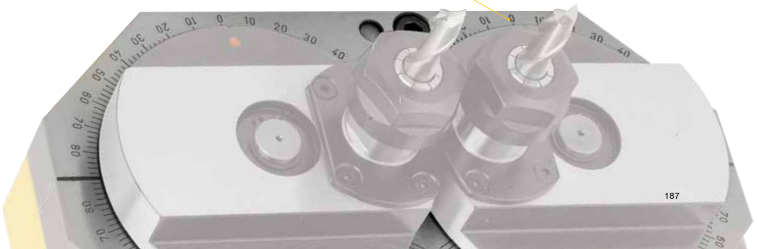
Piastra graduata per una registrazione facilitata dell'interasse Graded plate for easy centre distance adjustment
